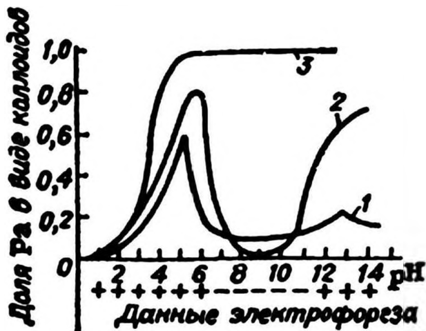
Рис. 9. Зависимость состояния протактиния-233 при концентрации \sim 10^{-12} моль/л от рН раствора:
